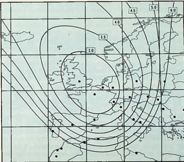
**Bild 1: Ausleuchtzone des European Communication Satellite ECS, Spot West**
