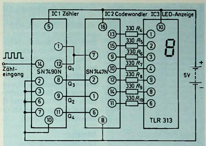
Bild 3.7.15: BCD-Zähler mit 7-Segment-Anzeiger und zwischengeschaltetem BCD/7-Segment-Wandler
