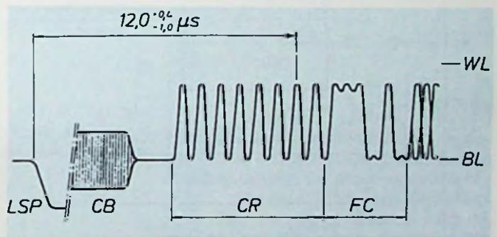
Bild 6: Anfang einer Videotextzeile, CR  $\triangleq$  Clock run in „10101010 10101010“, FC  $\triangleq$  Framing code „11100100“ ▲
