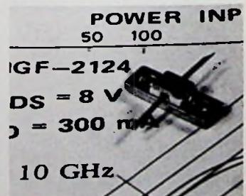
**Bild 1: GaAs-FET für hohe Leistung bei 12 GHz** (Municom-Pressbild)
