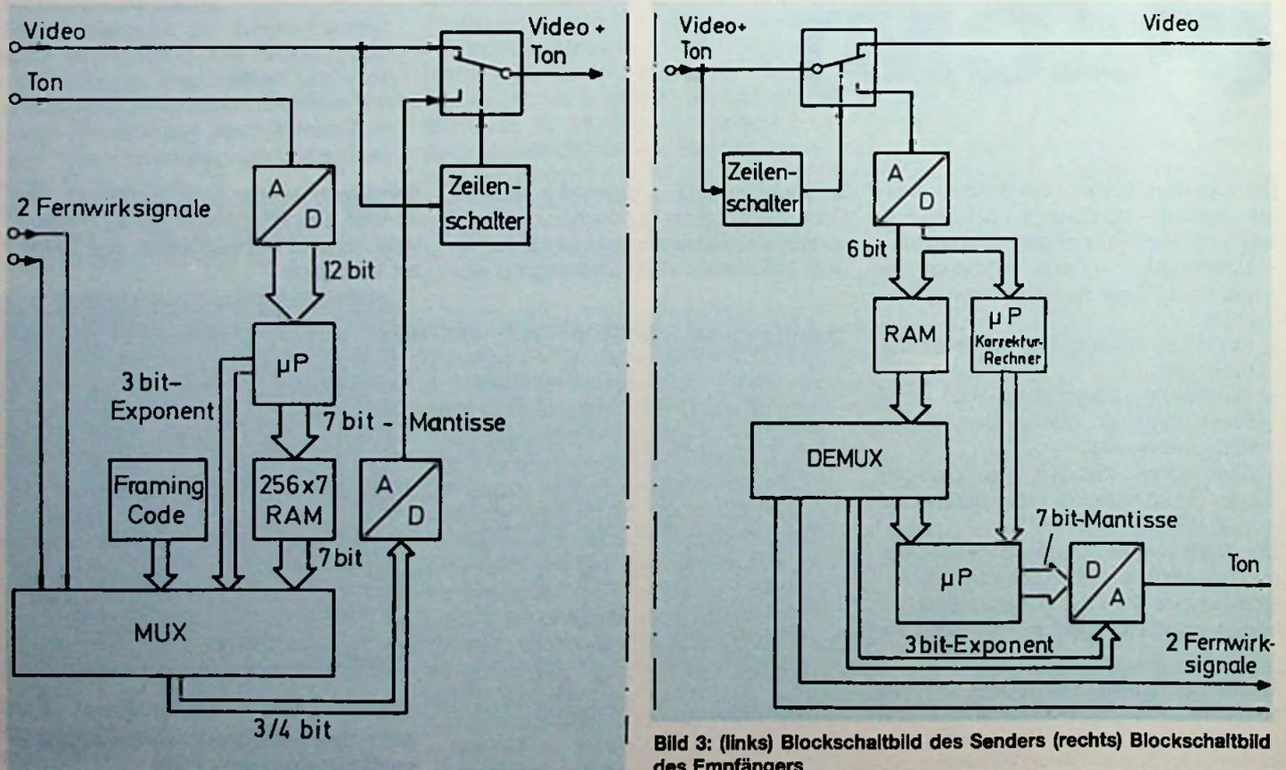
Bild 3: (links) Blockschaltbild des Senders (rechts) Blockschaltbild des Empfängers
