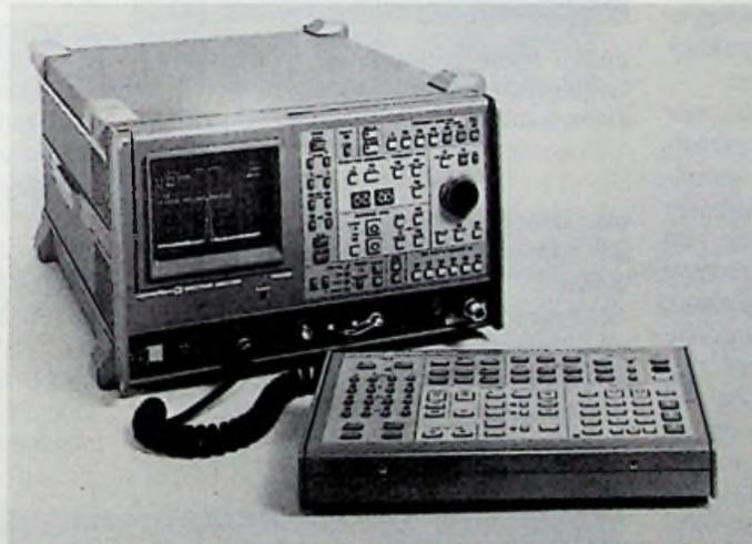
**Bild 1: Mikrowellen-Spektrumanalysator bis 20 GHz** (RSE-Pressbild)
