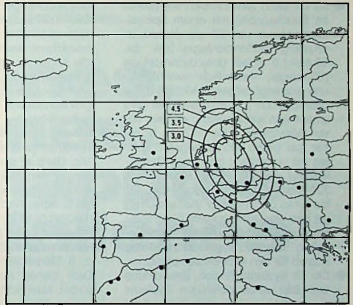
**Bild 2: Ausleuchtzone des Deutschen Fernmeldesatelliten „Kopernikus“**
