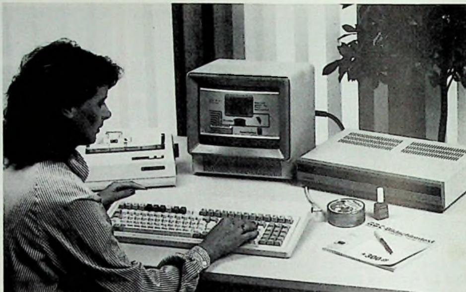
**Bild 7: Vollständiger Btx-Arbeitsplatz. Rechts der Beistelldecoder DC 3 (Blaupunkt-Pressbild)**
