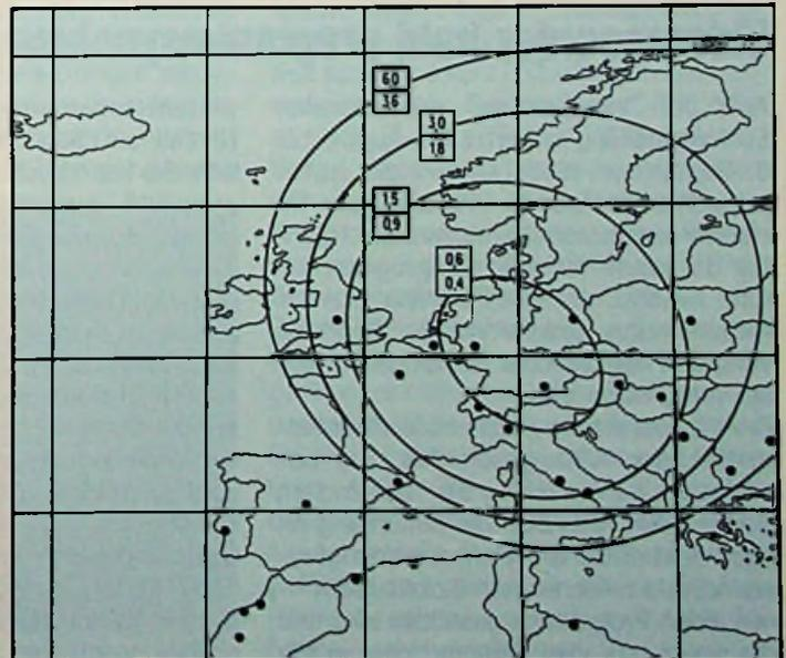
**Bild 4: Ausleuchtzone des Rundfunksatelliten TV-SAT**
