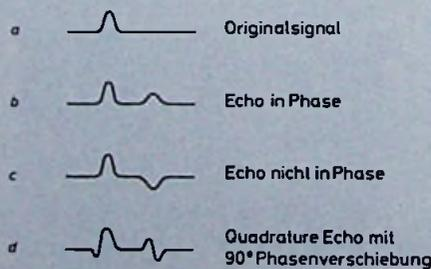
**Bild 2: Impulsformen unter dem Einfluß von Echosignalen**
