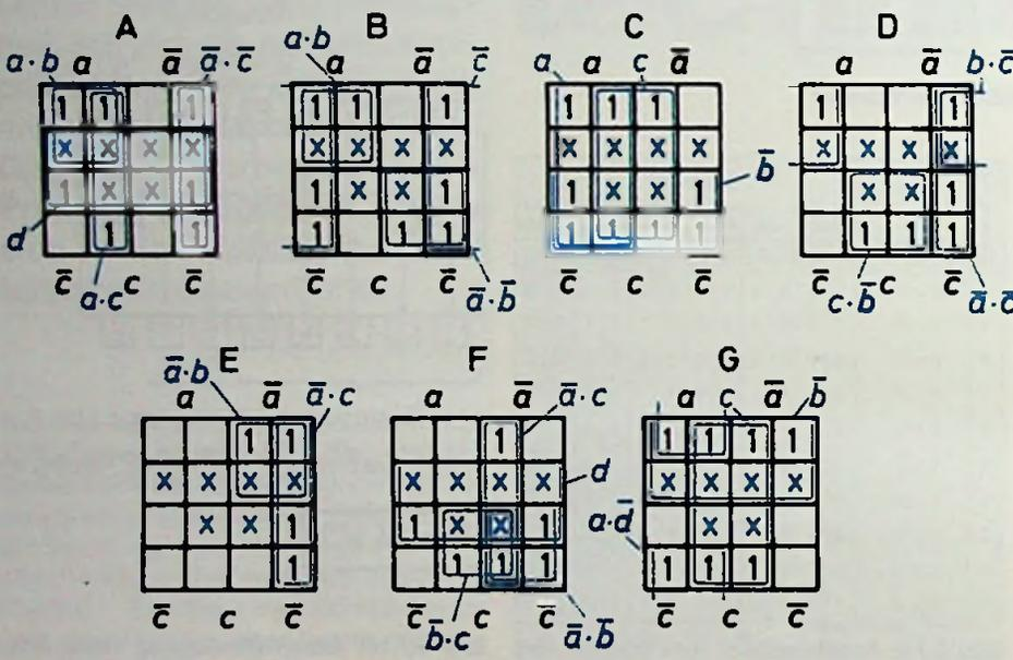
Bild 3.7.12: KV-Tafeln zur Minimierung eines BCD/7-Segment-Wandlers
