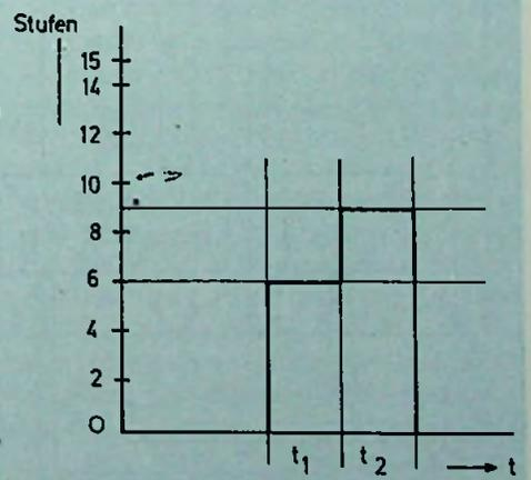
Bild 1: Umwandlung der 7-bit-Mantisse in 2 amplitudenquantisierte Pulse
