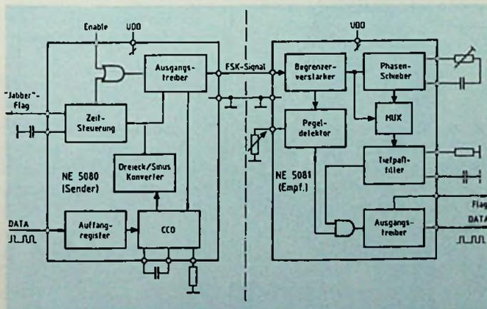
Bild 1: Schaltung des FSK-Modems
