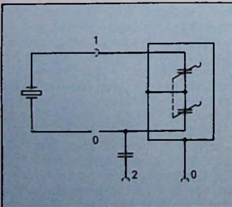
Bild 11: Transistordipper als Quarztester
