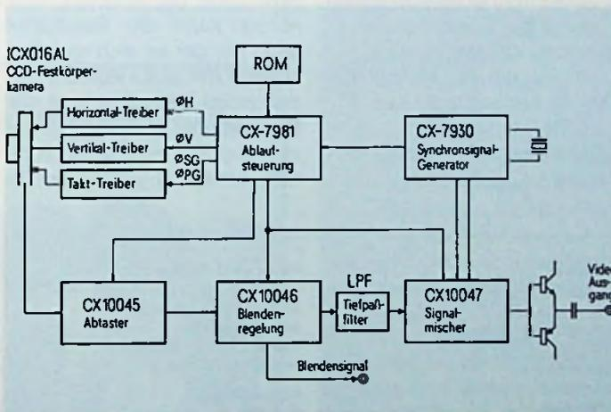
Bild 1: Anwendung des Mehrnormen-Video-Taktgenerators in einer CCD-Kamera (Framos-Pressebild)
