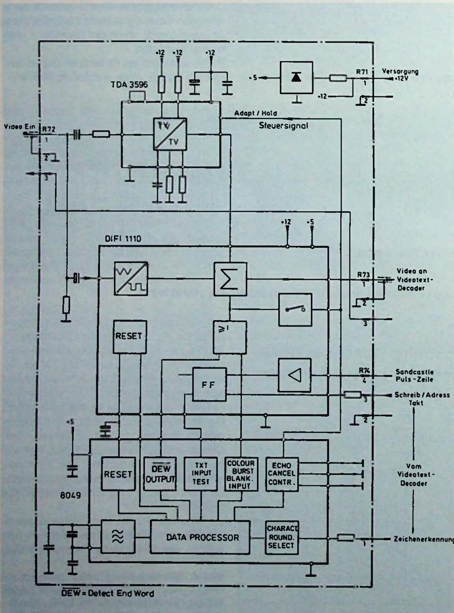
Bild 8: Innere Funktion der kompletten Echoentzerrerschaltung
